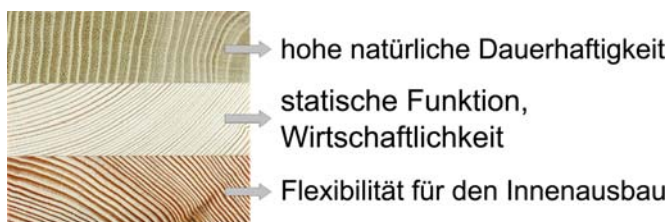
Bild 1: Trennung des Fensterkantels in verschiedene Funktionsbereiche (Quelle: Holzforschung Austria)
